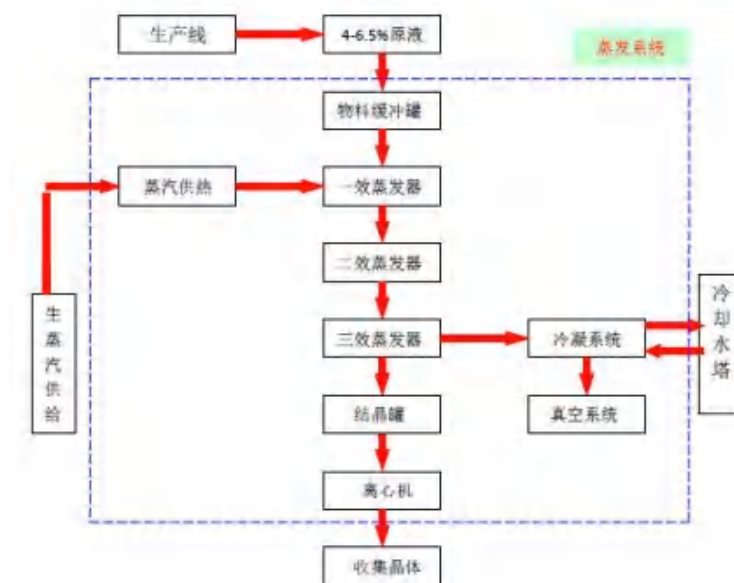
图 3.3.5.1-3 三效蒸发工艺流程图
